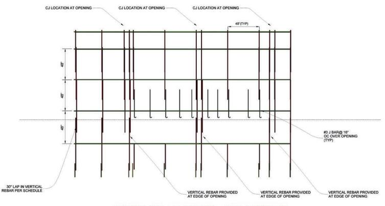
**TYPICAL WALL ELEVATION - TWO OPENINGS**
